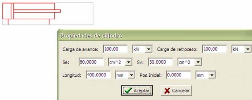
Figura 2. Modificación de las características geométricas y operativas de un actuador hidráulico a través del uso de menús contextuales.
