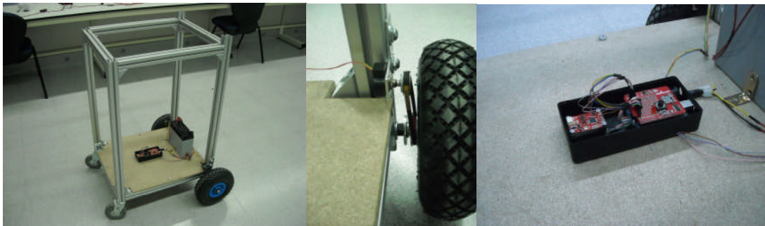
Figura 5. Fotografías del sistema desarrollado, donde se puede observar de izquierda a derecha: Carro, detalle de ruedas y encoder y placa del microcontrolador Arduino Uno
