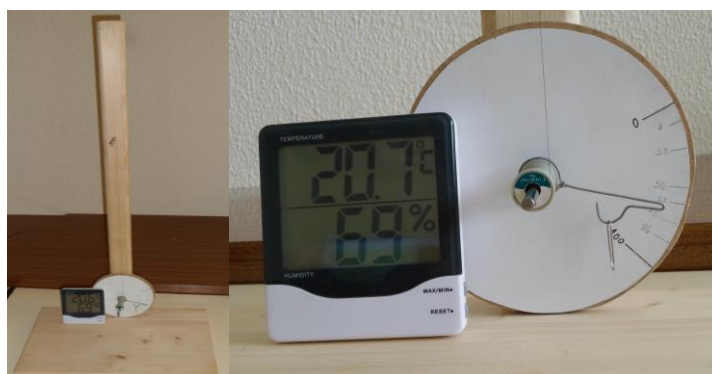
Figura 2. Higrómetro de um fio de cabelo e comparação de leituras entre o higrómetro construído pelos estudantes e um digital
